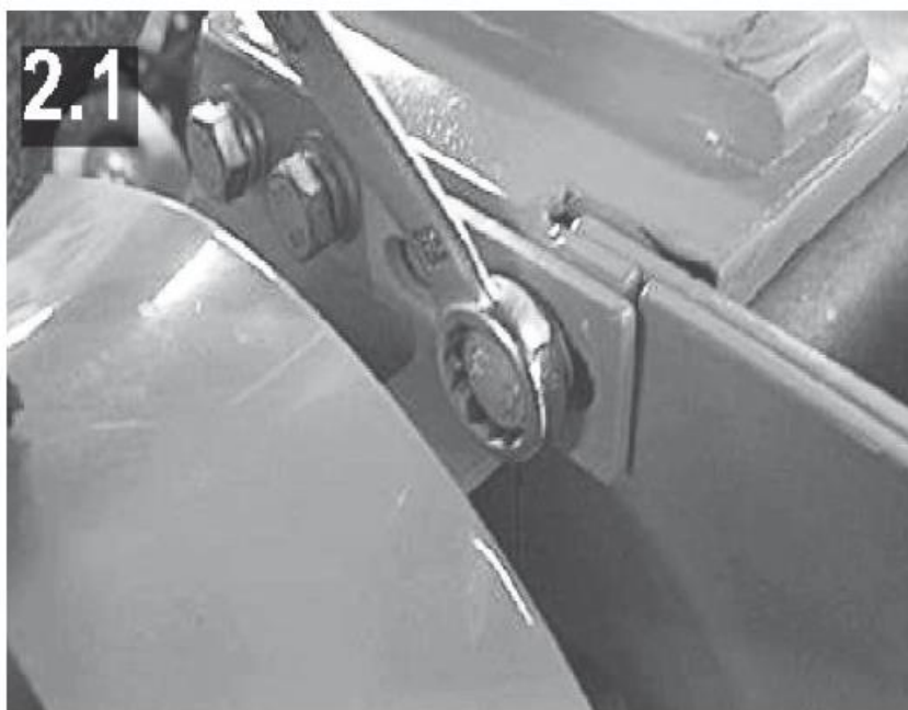
Destrângeți șuruburile de fixare ale motorului (imag. 2.2)
