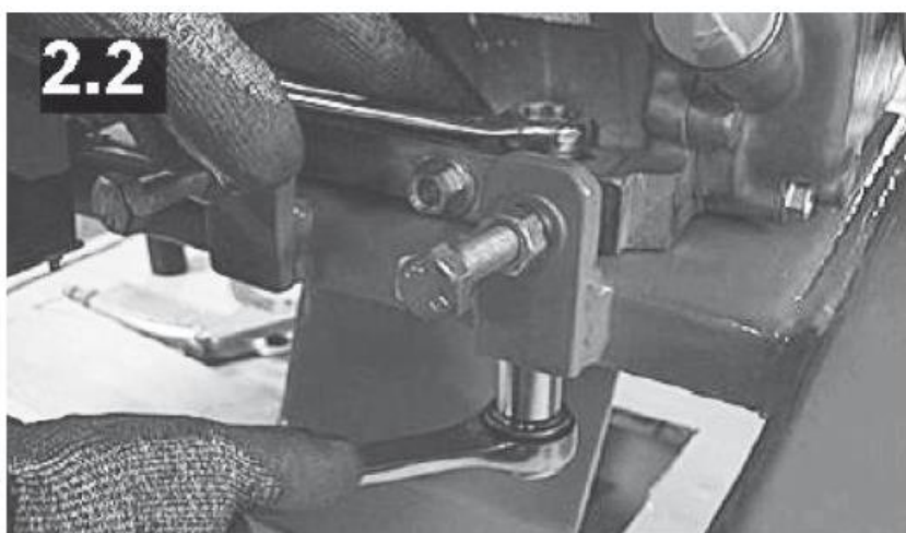
Destrângeți puțin șuruburile de fixare ale motorului (imag. 2.3)
